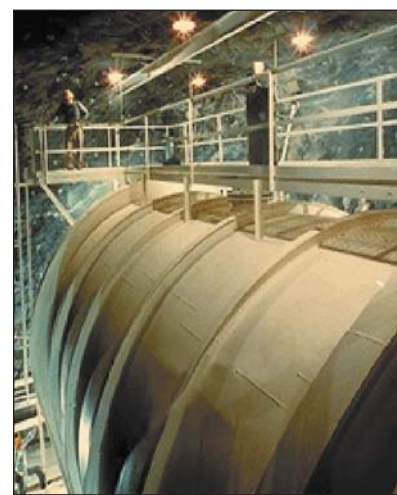
Рис.4. Первый радиохимический детектор по регистрации солнечных нейтрино, шахта Хоумстейк, Северная Дакота (1964—1968).
